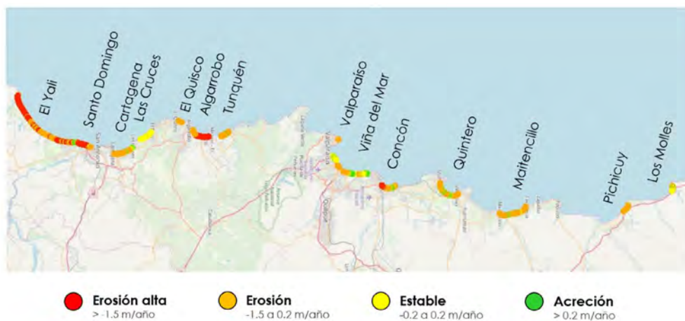
Figura RE-5. Cambios en la línea litoral para playas de la Región de Valparaíso.
