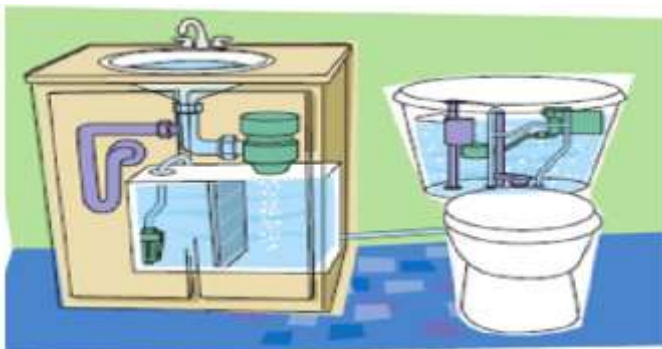
Figure 33: dispositifs de plomberie qui utilisent l'eau grise des éviers pour la chasse d'eau des toilettes
