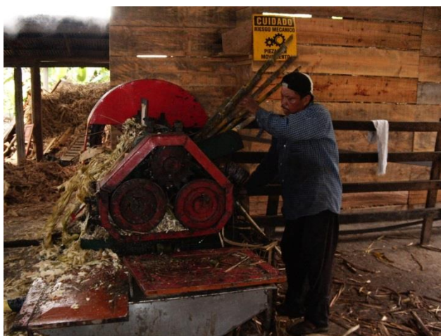
Fotografía 4. Molino horizontal de tres mazas. (La Tobiana, Quebrada Negra, Tobia, Cundinamarca)
