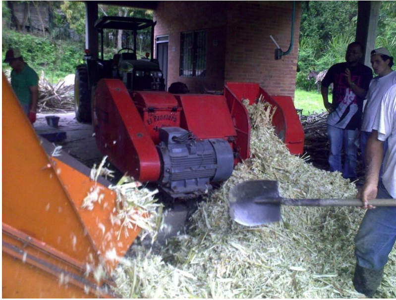
Ilustración 15 Molino eléctrico en la planta piloto de Tobia
