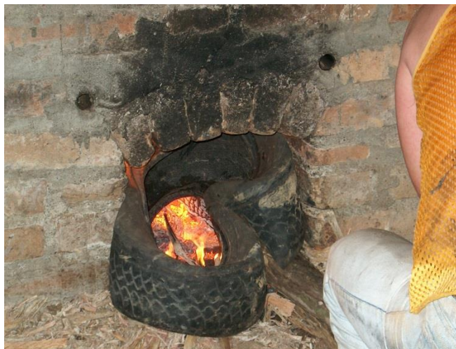
Fotografía 14. Uso de llanta en una hornilla panelera de Caparrapí
