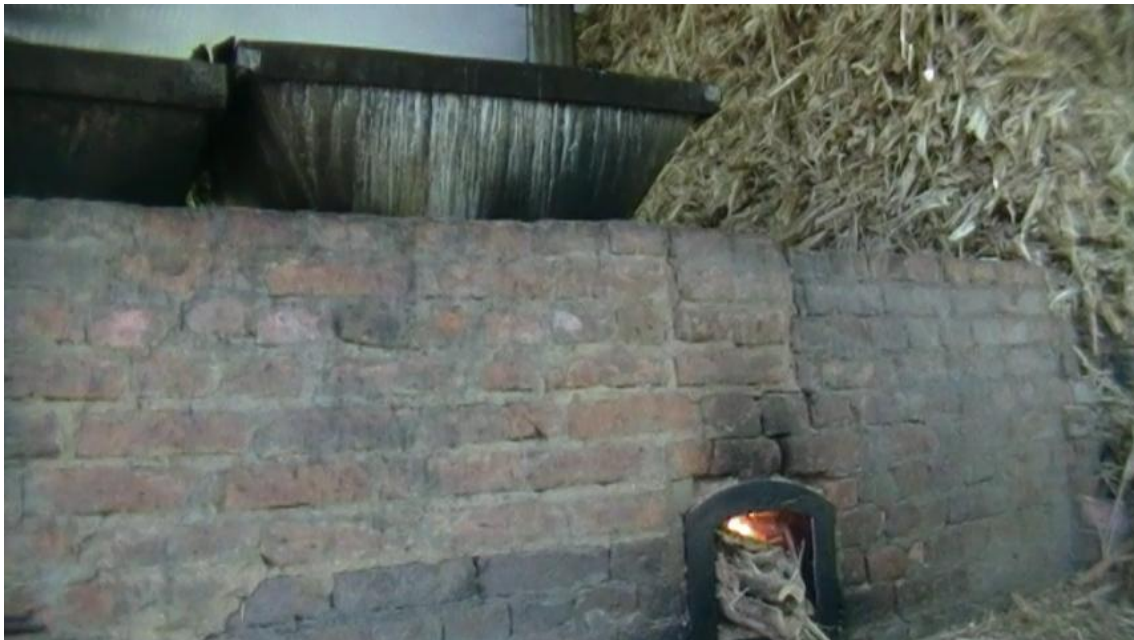
Ilustración 6. Cámara de combustión en una unidad de producción panelera tradicional
