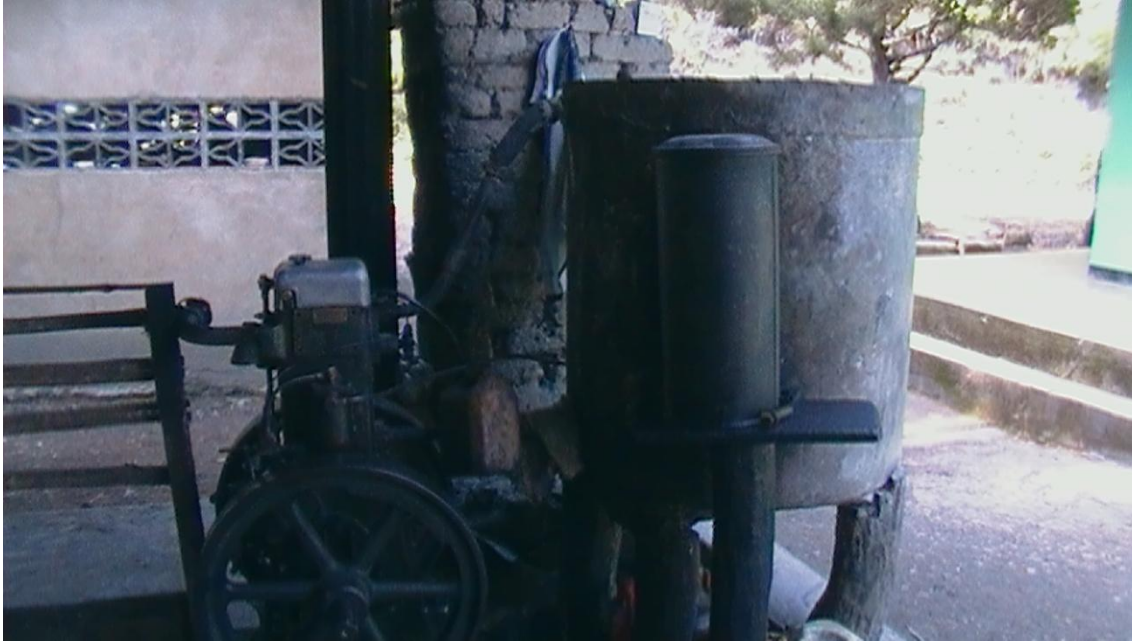
Ilustración 2 Motor diesel que impulsa los rodillos para extracción de jugos de la caña panelera.
