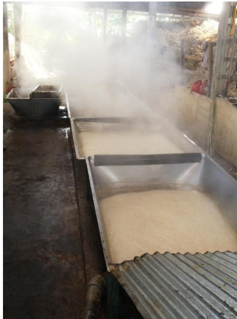
Fotografía 10. Evaporación y concentración de jugos. (La Tobiana, Quebrada Negra, Cundinamarca)
