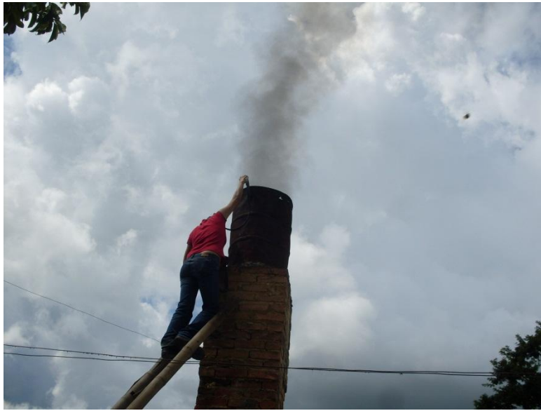
Ilustración 30 Medición de humos con equipo Baccarach
