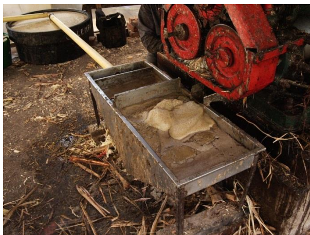
Fotografía 6. Prelimpiador en acero. (La Tobiana, Tobia, Quebrada Negra, Cundinamarca)
