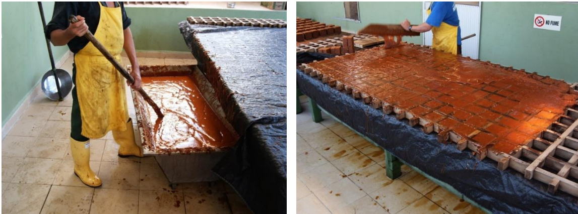
Fotografía 11. Batea para el batido de la miel y moldeo de la Panela
