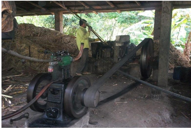
Ilustración 12 Utilización de motores diesel para la extracción de los jugos.
