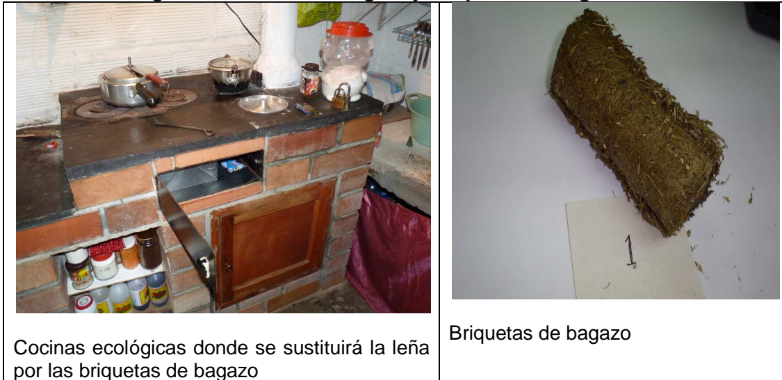
Figura 8. Cocina ecológica y briqueta de bagazo
