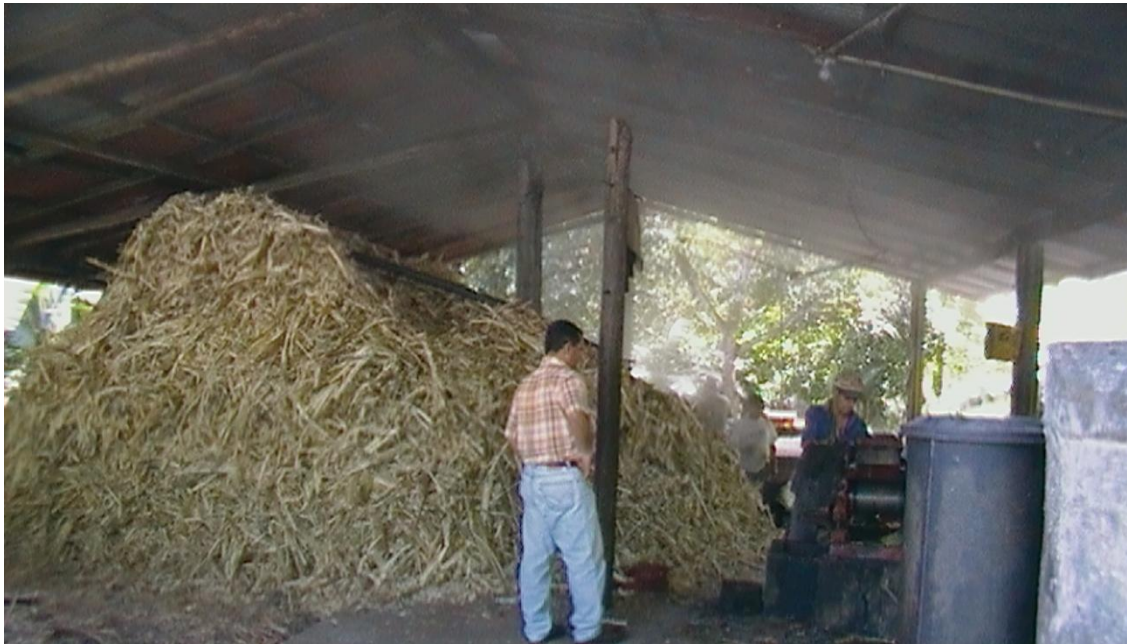
Ilustración 10 Bagazo utilizado para la combustión en el proceso de evaporación. En las unidades lo dejan secar acumulado hasta dos meses en temporadas secas de tal forma que pueda hacer ignición en la hornilla.
